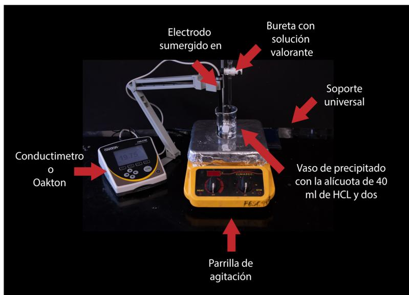
Figura 4.2.2. Montaje experimental para realizar la valoración conductimétrica
