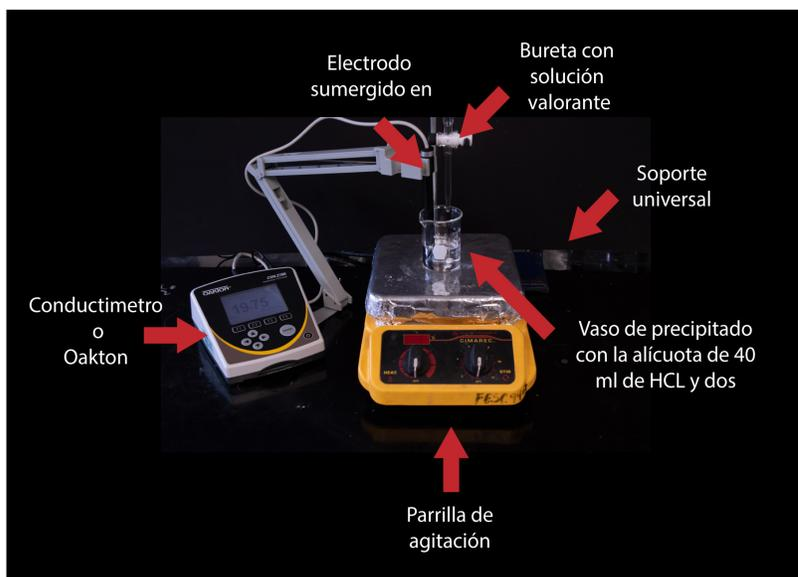
Figura 4.2.2. Montaje experimental para realizar la valoración conductimétrica
