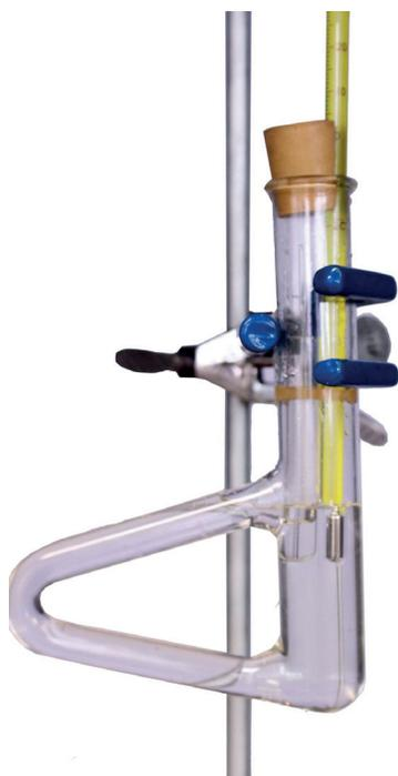
Fig. 11. Montaje para determinar punto de ebullición.
