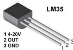
Fig. 18. Sensor de temperatura LM35 (Fuente: Internet).
