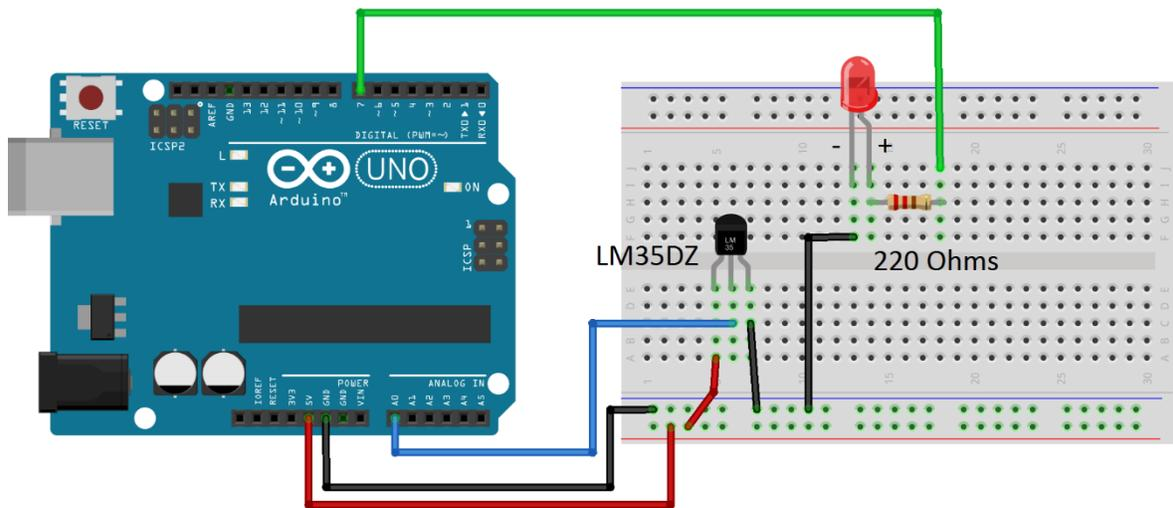
Fig. 19. Esquema de conexiones del sensor de temperatura y un LED.
