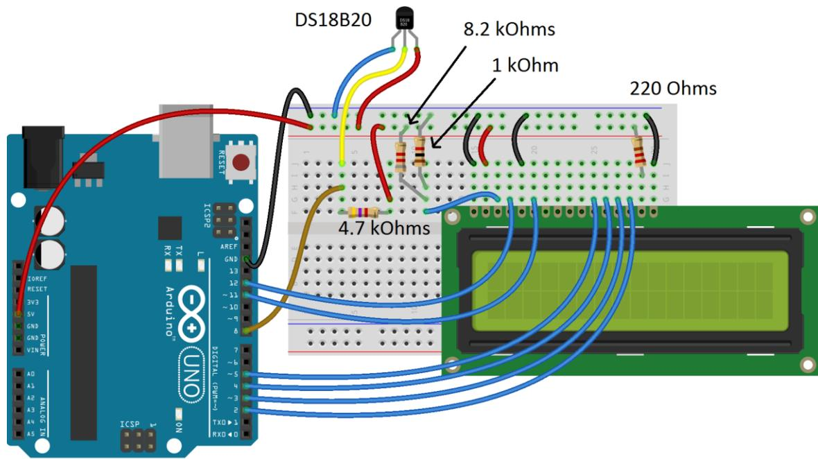
Fig. 34. Diagrama de conexiones del LCD y un sensor de temperatura DS18B20.
