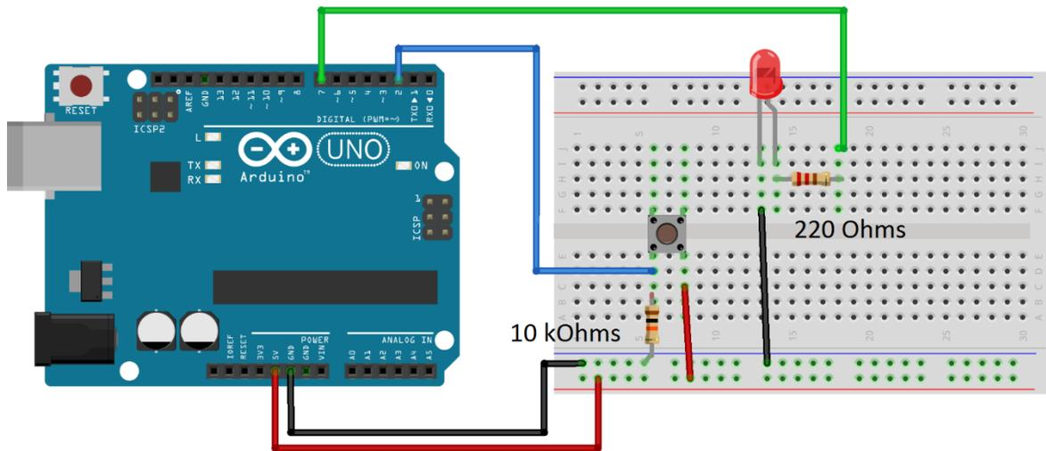
Fig. 10. Diagrama de conexiones de un circuito con interruptor y LED.
