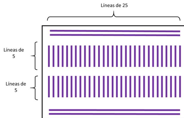
Fig. 11. Diagrama de conexiones internas de una protoboard.
