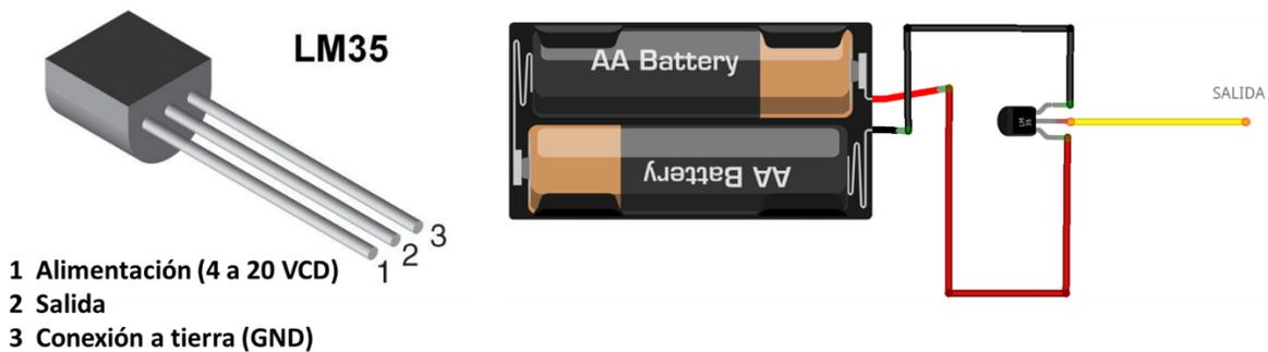
Fig. 29. Identificación de las terminales del sensor de temperatura LM35 (a la izquierda), y ejemplo de conexión (a la derecha).
