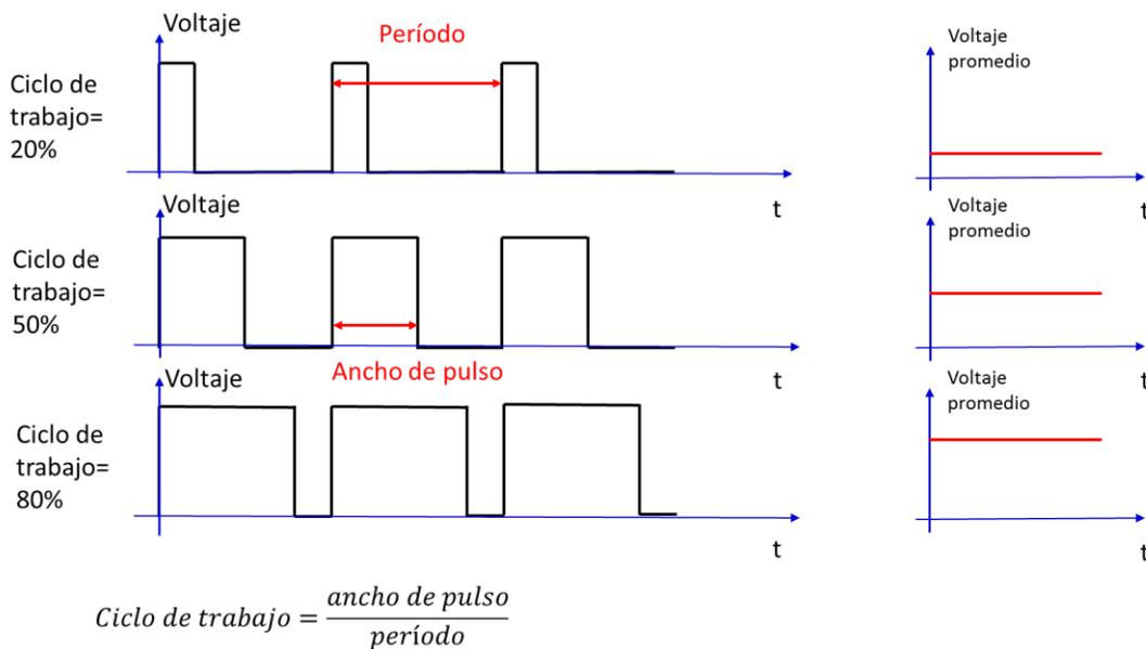
Fig. 43. Ejemplos de una señal de modulación por ancho de pulso.
