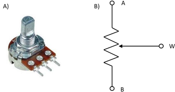
Fig. 22. Potenciómetro. A) Fotografía (Fuente: Internet). B) Diagrama eléctrico.
