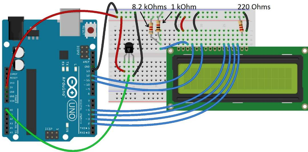
Fig. 30. Conexiones para el ejemplo del manejo de un LCD y un sensor de temperatura (modificado de los ejemplos del programa Fritzing)
