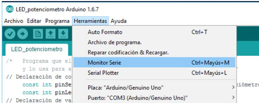
Fig. 25. Activación del Monitor Serie dentro del menú de Herramientas.
