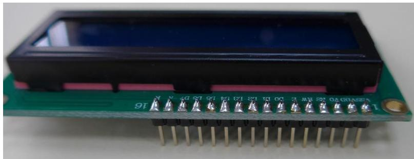
Fig. 31. Tira de pines soldada al display LCD.
