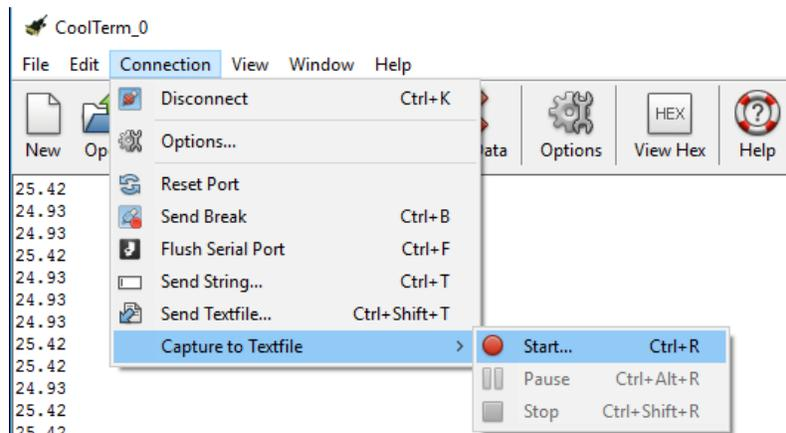
Fig. 27. Activación del registro de datos en el programa CoolTerm.
