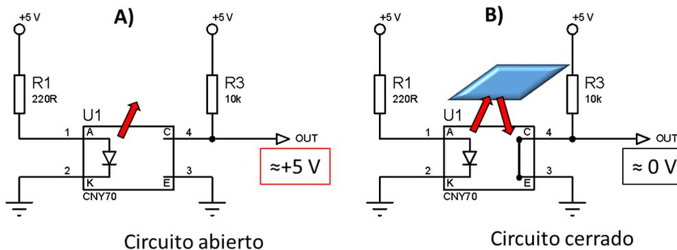
Fig. 37. A) Operación cuando no hay un objeto reflejante. B) Operación cuando sí hay un objeto reflejante.
