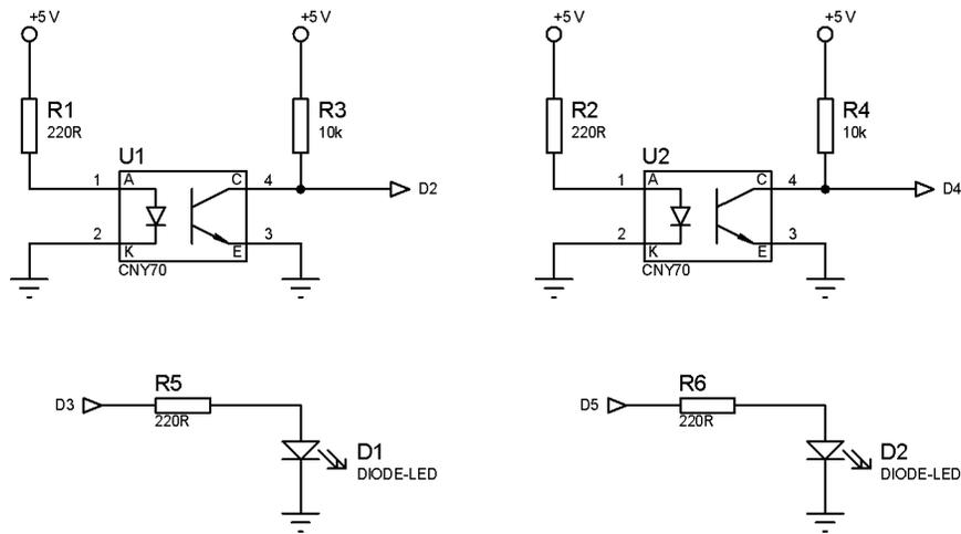
Fig. 38. Diagrama electrónico de los sensores y LEDs para realizar un cronómetro. Se indican las conexiones D2 a D5 hacia la tarjeta Arduino.
