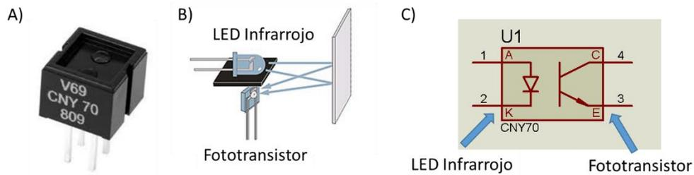
Fig. 36. A) Imagen de un opto-interruptor reflexivo. B) Funcionamiento de un opto-interruptor. C) Símbolo electrónico. (Fuente A y B: Internet).
