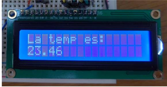
Fig. 32. El display LCD mostrando la temperatura ambiente.
